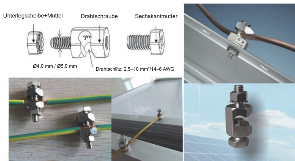
Abbildung 5: Installationsmethoden
