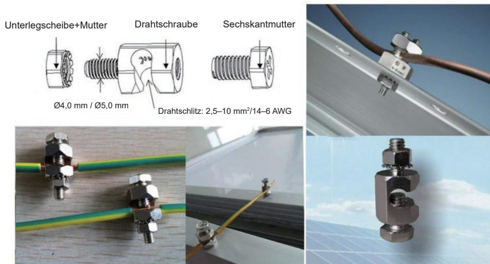
Abbildung 6: Installationsmethoden
