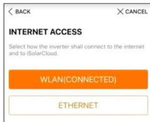
Abbildung 7-5 Auswählen des Internetzugangsmodus
