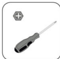
Kreuzschlitzschrau- bendreher (M3, M4, M6)
