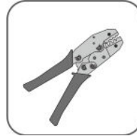
Crimpwerkzeug für Aderendhülsen (0,5 mm 2 –1 mm 2 )
